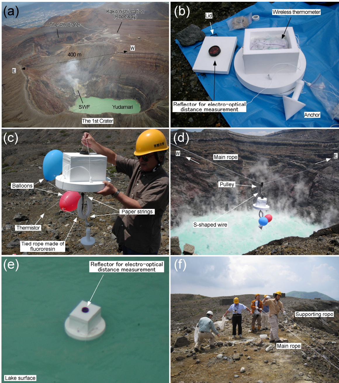
図 2. (a) 阿蘇火山中岳火口群の空中写真。SWF は南壁噴気孔群の位置を示す。(b), (c) 水温観測ブイ 2 号機の写真。(d) 主ロープを用いた水温観測ブイ 2 号機設置の様子。(e) 湯だまり湖面に設置された水温観測ブイ 2 号機。(f) 主ロープと副ロープの操作。
