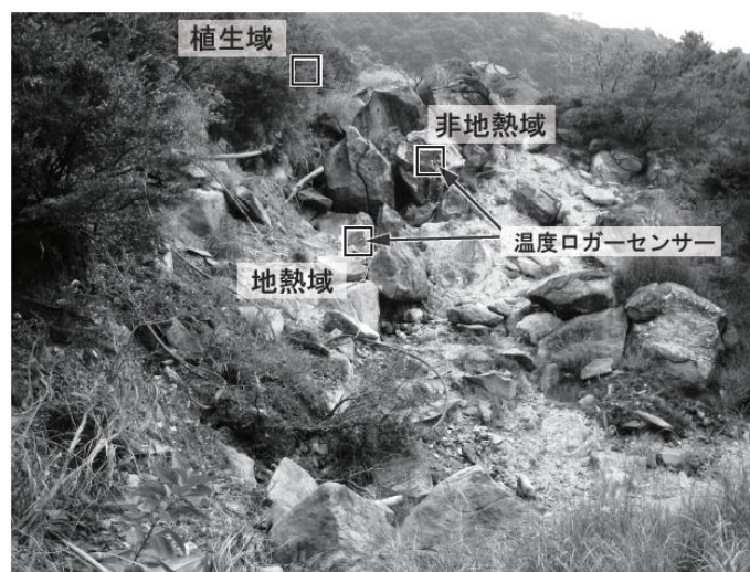
図 4. 熱映像撮影地点 B からみた領域 B の全景と温度ロガーセンサーの設置位置。図中の矩形は、図 6 の赤外面像上での温度の読取領域に対応する。（撮影距離：撮影場所から地熱域までは約 21m、非地熱域までは約 22m）
