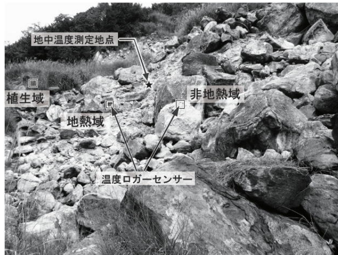
図 3. 熱映像撮影地点 A からみた領域 A の全景と温度ロガーセンサーの設置位置。あわせて地中温度測定地点の位置を星印で示す。図中の矩形は、図 5 の赤外面像上での温度の読取領域に対応する。（撮影距離：撮影場所から地熱域までは約 23m、非地熱域までは約 15m）
