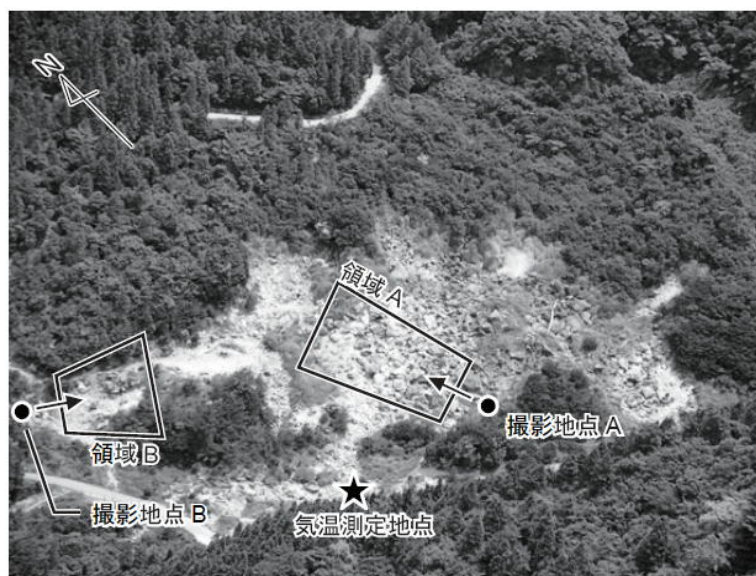
図2. 地獄温泉の地熱地域の全景写真 気温の測定地点を星印で示す。また、赤外面像の撮影地点2箇所(A・B)とその撮影方向をそれぞれ丸印と矢印で示す。さらに赤外面像で撮影した領域(領域A・領域B)のおおよその範囲もあわせて示す。
