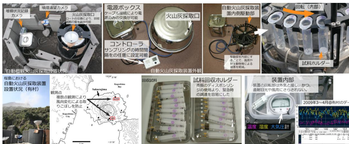
Fig. 1 桜島南西有村川における自動火山灰採取装置の設置状況および装置内部の構造。上段：左から順に、設置状況、コントローラ接続状態、内部試料ホルダー装着状態。下段：左から順に、有村での設置状況、観測点位置、回収直後の試料、装置に内蔵した温湿度大気圧計とその測定結果。
